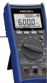
具备测量温度，直流电流mA， $\mu$ A级(4档量程：60.00 $\mu$ A/600.0 $\mu$ A，6.000mA/60.00mA)专用于控制系统，HVAC测量的客户量身定制。
